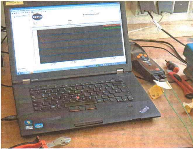
Bild 8: Aufzeichnung der Temperatur im Schutzrohr mit zwei Temperatur-Messfühlern (grün) unterschiedlicher Länge
