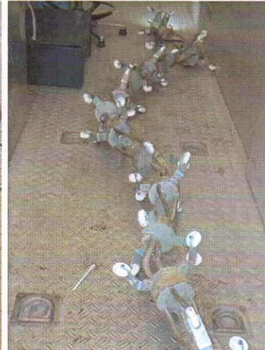
Bild 19: Lichterkette mit 8 x 600 Watt
